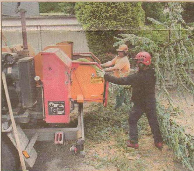
Das Geäst war für den Häcksler nur Kleinkram: Stämme bis 30 Zentimeter Durchmesser zerkleinert die Maschine mühelos.
